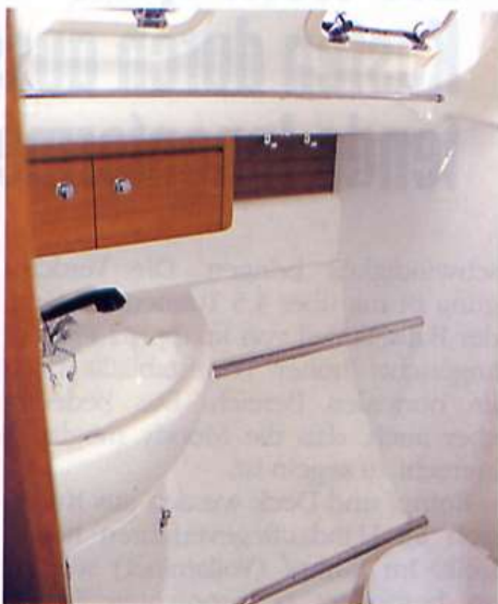
Fest eingebaute Haltestangen im Waschraum für Sicherheit bei Wind und Welle.
