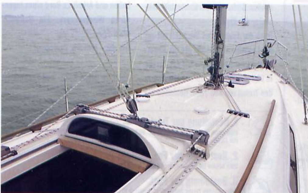
Diese Art der Großschottführung schafft ein freies Cockpit. Die Niederholerbedienung sollte ebenfalls nach achtern umgelenkt werden.
