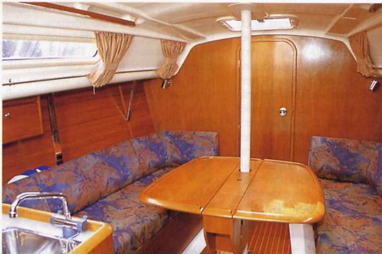
Die Seitenklappen des Salontisches sind mit angeformten Schlingerleisten versehen. Der Stauraum hinter den Lehnen ist offen.
