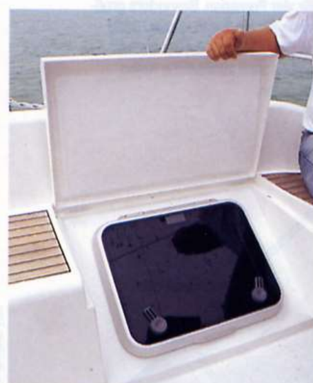
Unter einer Klappducht im Cockpit liegt die Licht- und Fluchtluke der Achterkajüte.
